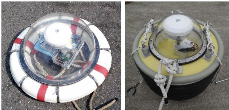
圖 2 本實驗所使用之浮標 (左)Waverider GNSS Buoy；(右)自製 GNSS 浮標
