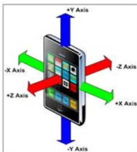
圖4 (a)手機三軸加速計感應器配置(加速度軸方向為手機右側為 X 軸正向、前端為 Y 軸正向、正面為 Z 軸正向)
