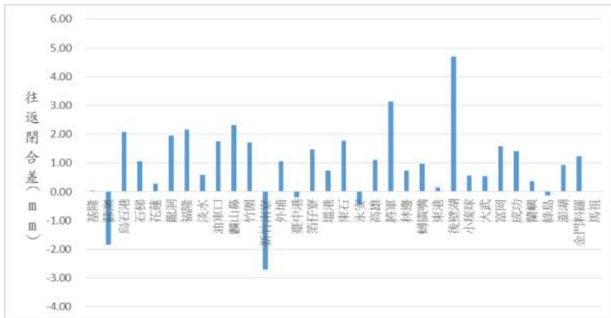
圖 4-1 潮位站高程基準檢測測線往返閉合差圖
