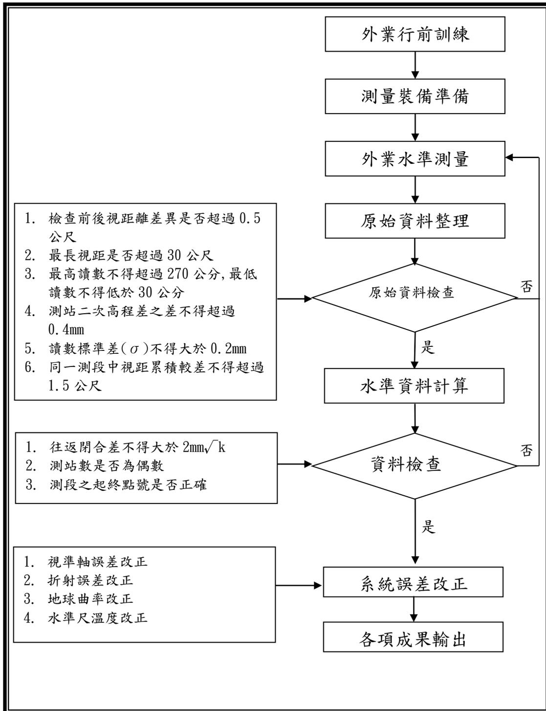
圖 2-2 高程基準檢測作業流程圖
