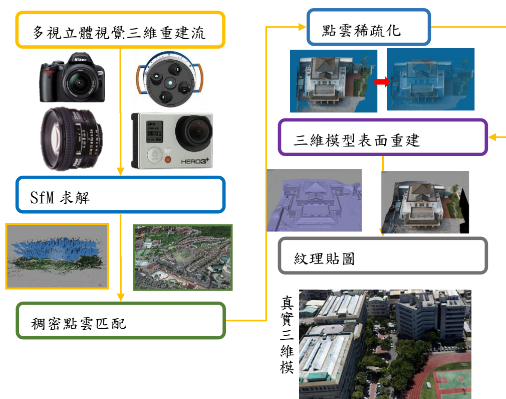
圖 22 傾斜影像三維建模流程
