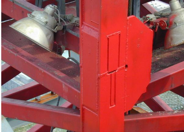
圖 10.4 塔節接合處焊接及增加立板
