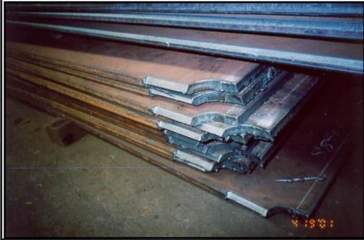
圖 7.22 組合型鋼之翼板與腹板接合處，端部再以回頭銲形成一平滑圓順
