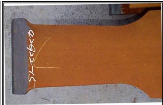
圖 7.21 組合型鋼之翼板與腹板接合處，採用提高一等級之開槽銲接方式
