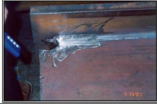
圖 7.23 銲後並切除翼板兩端多餘銲道及以研磨處理
