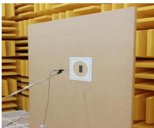
圖 2-4.2 研發之超薄型平面揚聲器試驗
