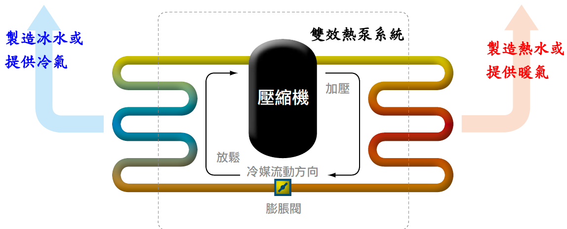
圖 3-19 雙效熱泵系統運作原理示意圖
