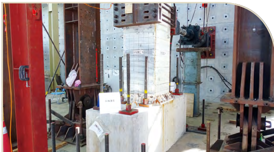
既有建築RC柱乾式鋼板補強試驗
