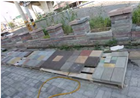
圖 6-5 再生高壓混凝土地磚
