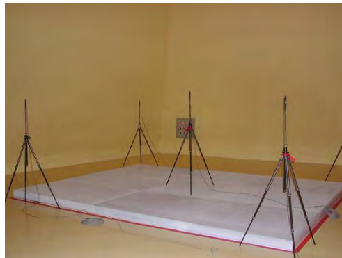
圖 7-22 吸音性能量測實驗室
