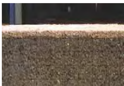
圖 7-24 透水性樹脂混合粒料之構造
