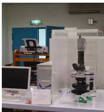
圖 3-2 偏光顯微鏡-石棉檢測設備
