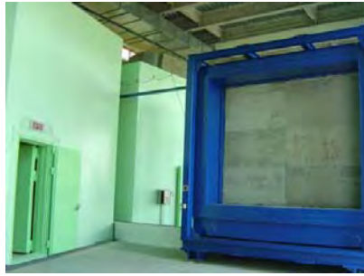
(a) 牆板隔音測試設施
