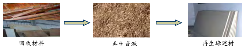
圖 6-2 木質材料回收製造再生綠建材流程
