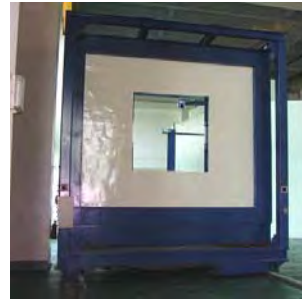
(b) 窗戶隔音測試設施
