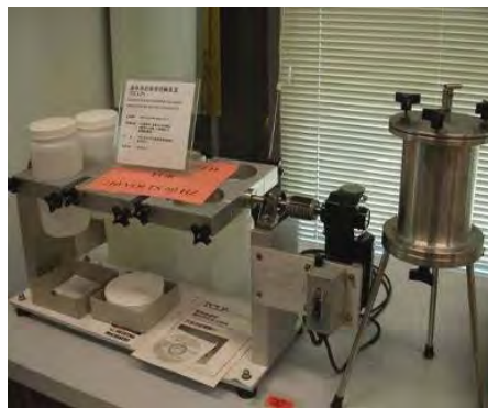
圖 3-3 TCLP 毒性溶出檢測設備
