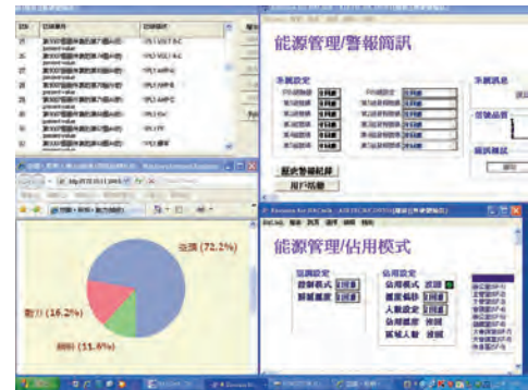
圖 1-4-8 設置能源監控系統進行能源使用管理
