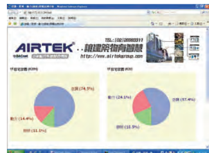
圖 2-7-6 建築物內能源資訊顯示系統
