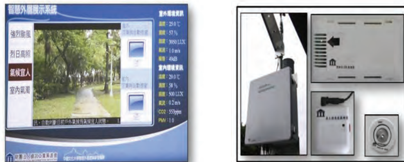
圖 2-7-5 智慧化居住空間展示中心智慧外層環境資訊顯示系統
