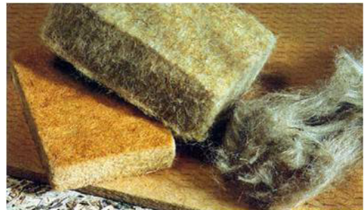
圖2-7.5 取代化學發泡材料的天然纖維隔熱材
