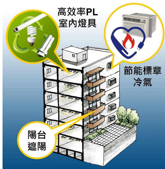
圖2-4.1 住宿類建築日常節能的重點
