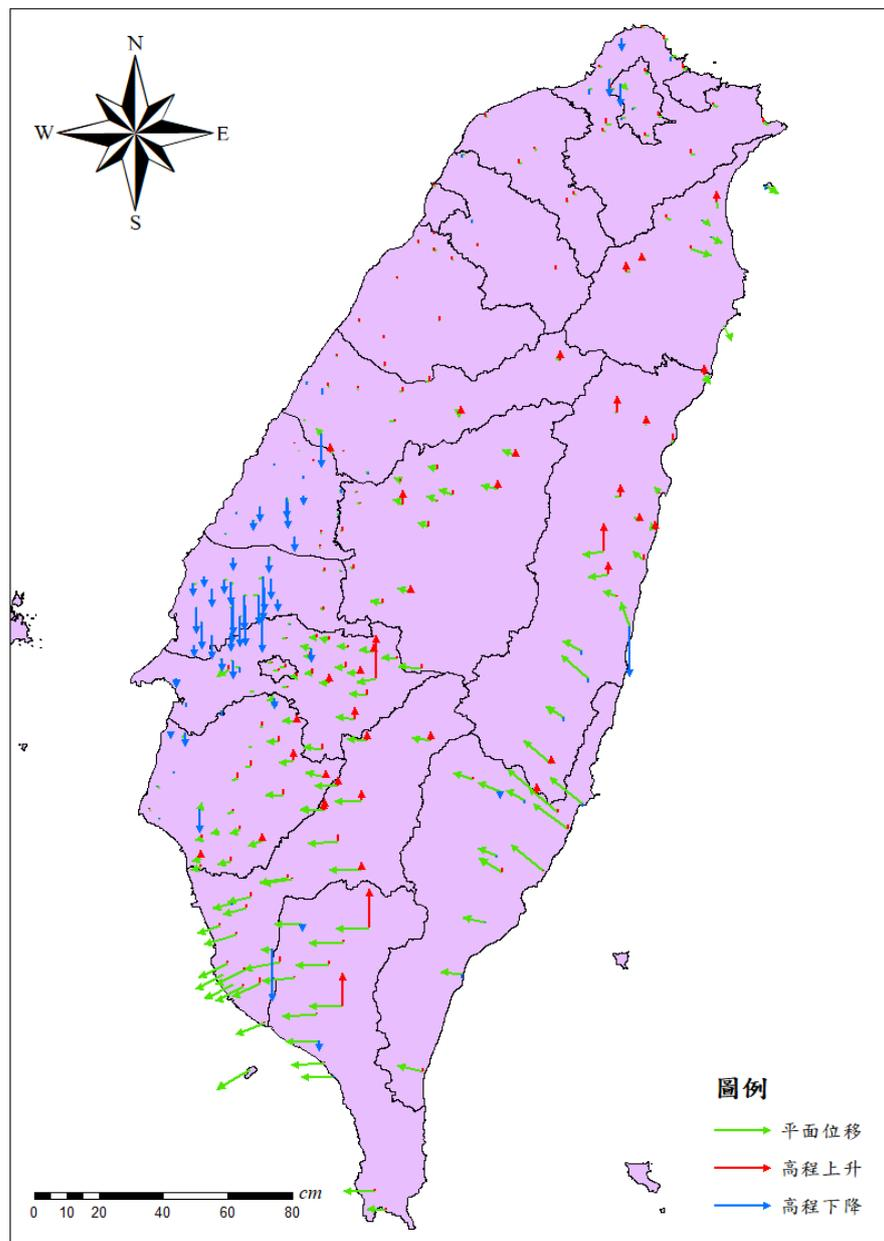
圖 2 大地基準站及一等衛星控制點(GNSS 連續站)位移向量圖
