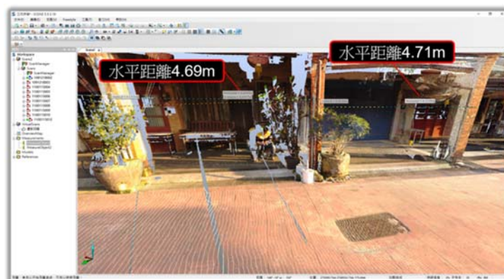
圖 20 FARO 點雲量距
