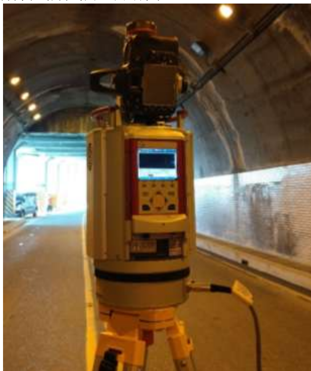
圖 9 RIEGL VZ-1000 三維雷射掃描儀(RIEGL LASER MEASUREMENT SYSTEMS GmbH, 2015)
