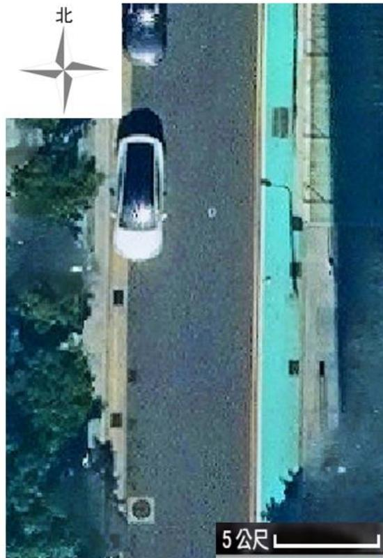
圖 17 真正射影像上之行人專用道、暗溝、排水溝蓋、人孔、道路邊界
