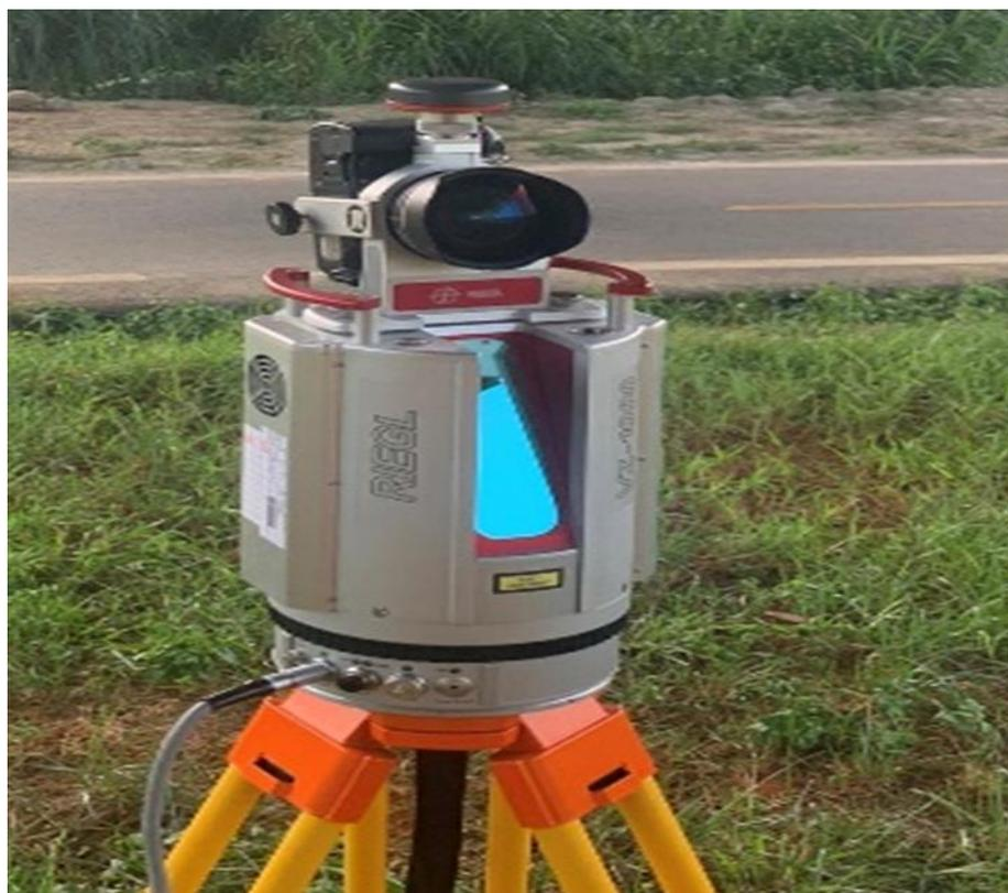
圖 8 Riegl VZ-1000 雷射掃描儀
