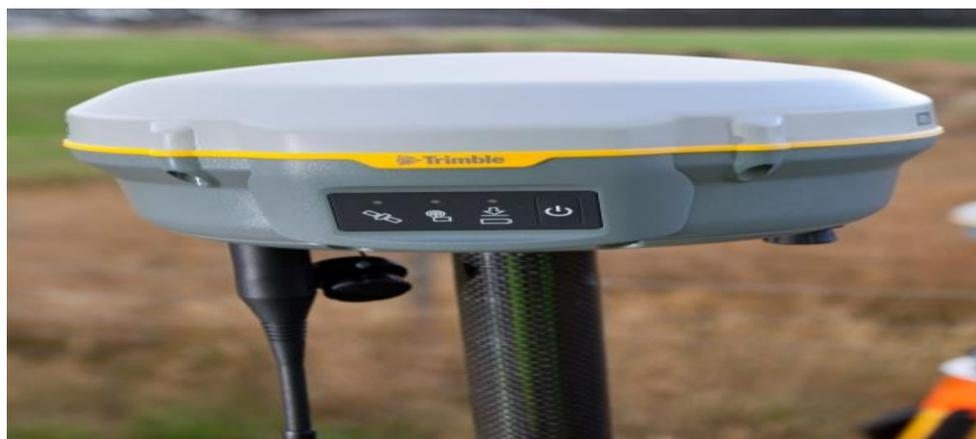
圖 6 Trimble R8s GNSS 衛星定位儀
