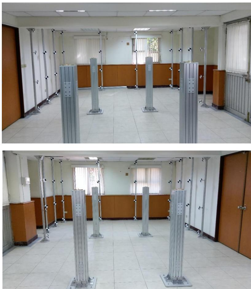
圖9 室內幾何校正場校正標與基樁布設圖(上圖朝南攝影，下圖朝北攝影)
