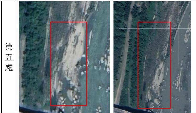
第五處為位於大溪人行陸橋西岸河道之河灘，此區域可參考大溪橋橋墩上之水位線標示以判斷大概水位，從點雲可看出有片狀之分流設施，周遭設有改變水流防止土壤侵蝕以保護橋墩之豆腐岩，見表 18，此區域受水流側向沖刷，2015-2017 年之 Google Earth 影像而言為受側向水流侵蝕，但 2017 年迄今之點雲及 Google Earth 影像皆顯示此區塊為堆積狀態，見表 19，研判水流於此處受人行陸橋影響減緩，故於此處產生堆積。
