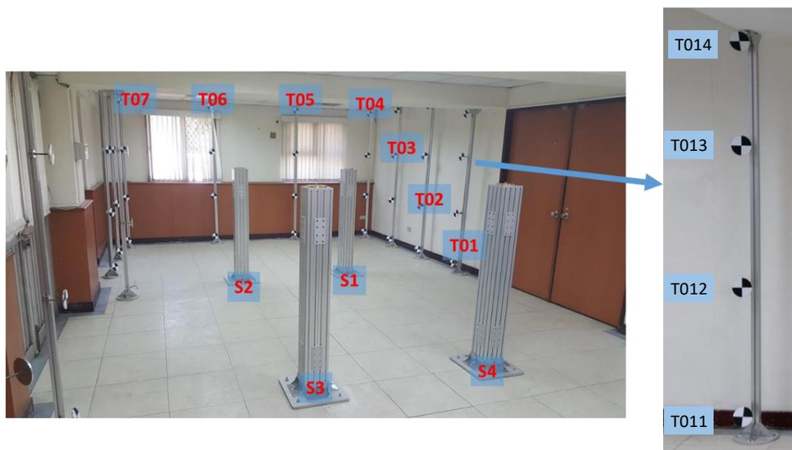
圖15 室內校正場設置與校正標
