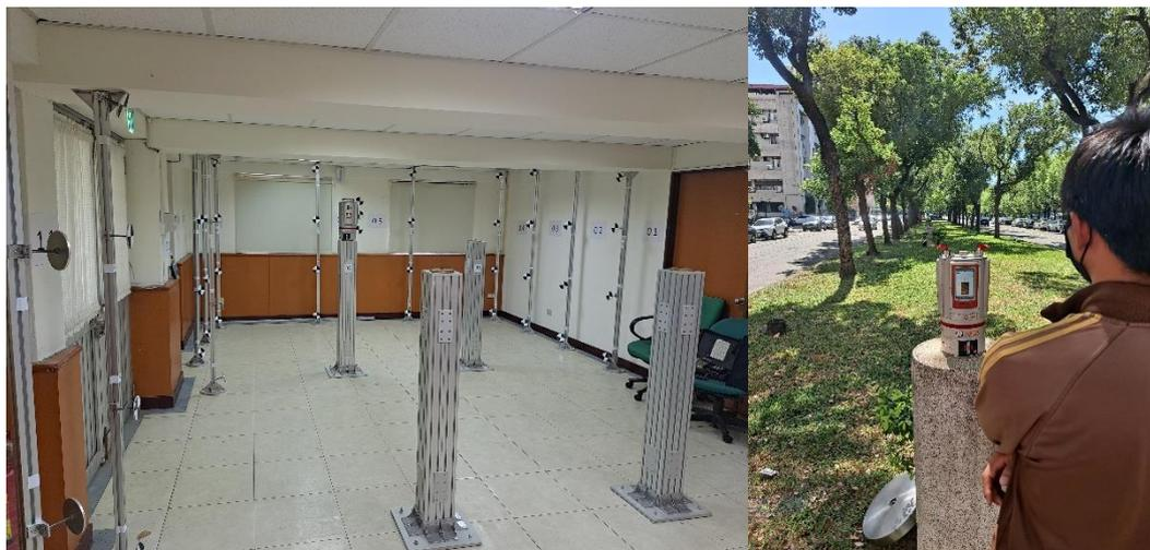
圖22 室內幾何校正場(左)及室外距離校正場(右)校正情形
