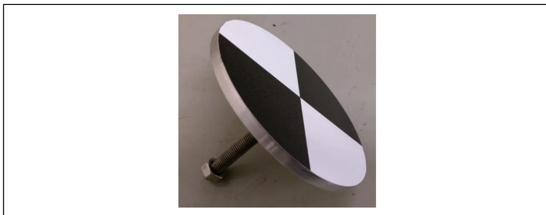
圖7 室內幾何校正場校正標製作成果樣式
