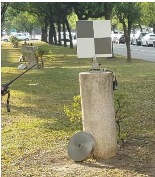
圖12 測距基線校正場校正標布設圖
