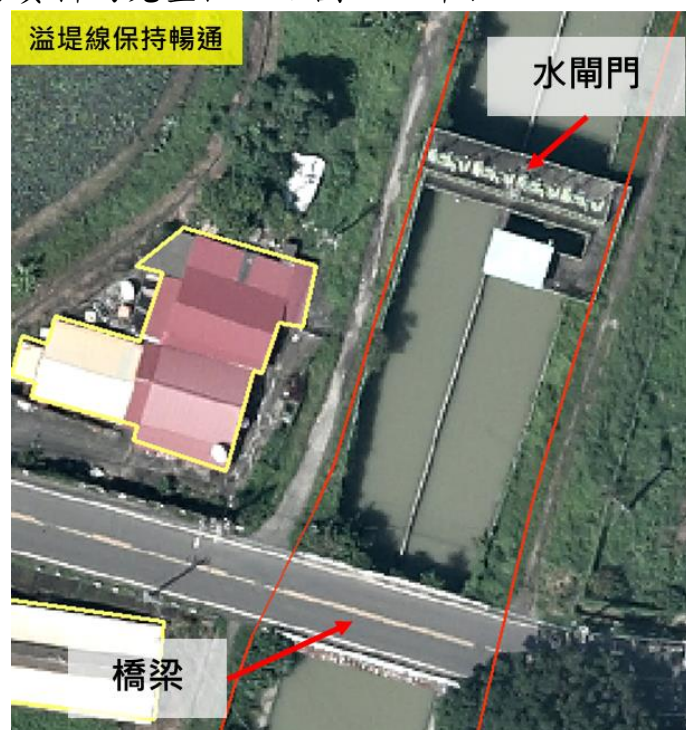
圖 3-6、溢堤線遇水閘門繪製原則(1)
