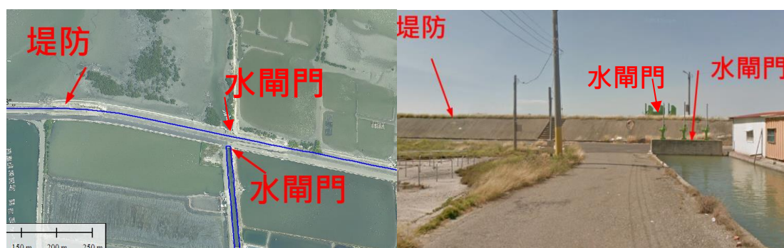
圖 3-7、溢堤線遇水閘門繪製原則(2)
