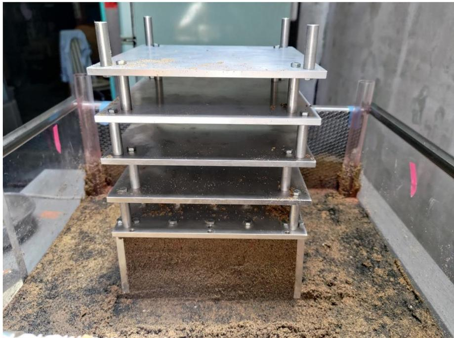
圖 5-75 裝設 8.7cm 連續壁及填砂作業
