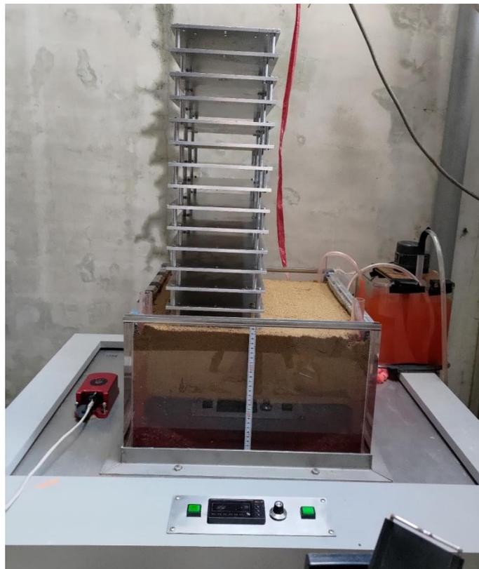
圖 5-85 20X40 地下 1 層加 8.7 壁體 14 樓模型備妥情況
