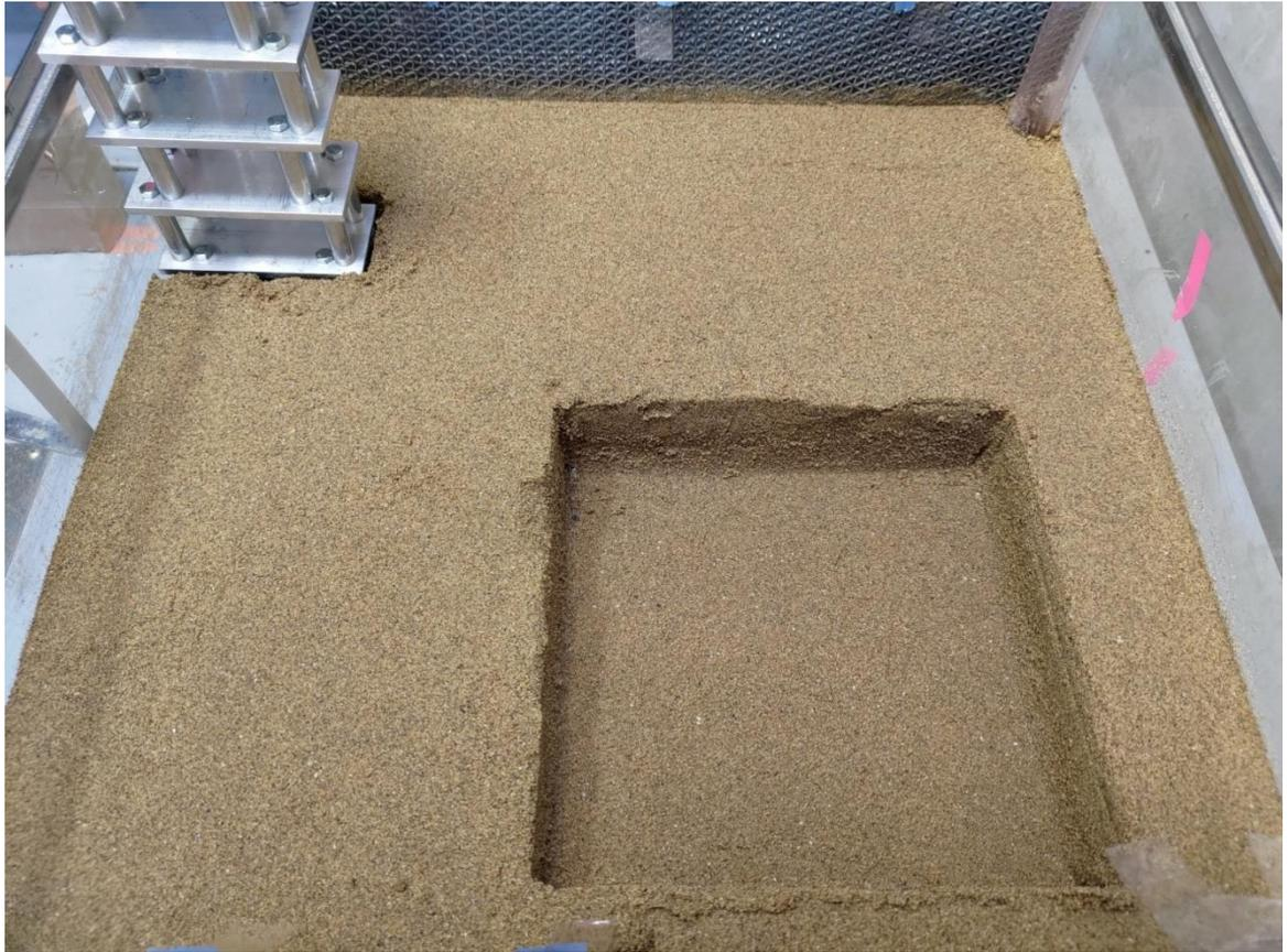
圖 5-29 地下開挖基坑情況
