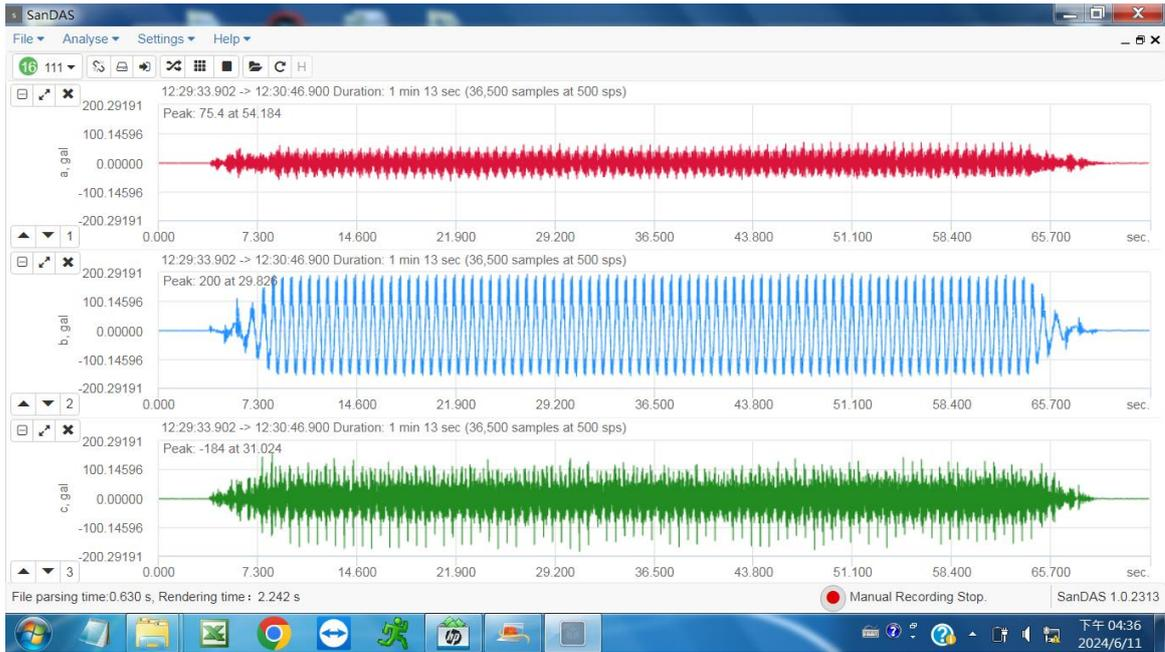
圖 5-35 加速度計顯示圖形(僅取用中間藍色曲線單向數據)
