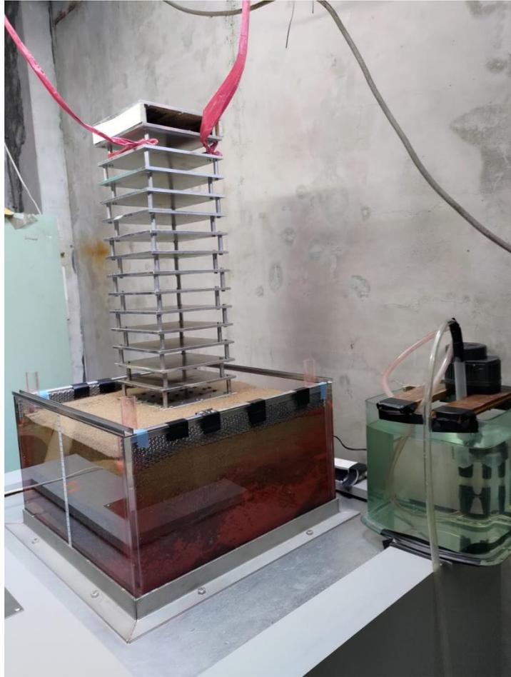
圖 5-76 基樁貫入至礫石層 8.7 壁體 20cm 正方 15 樓模型完成情況
