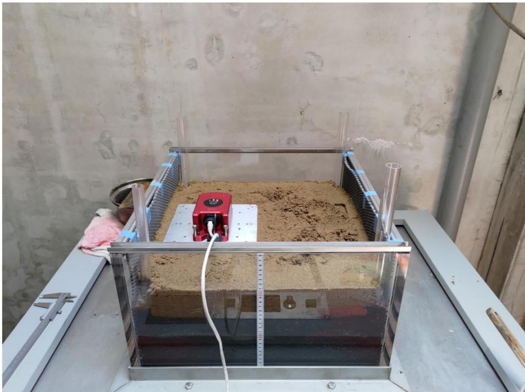
圖 5-34 將加速度計移入砂箱內不同位置，量測加速度反應差異情況
