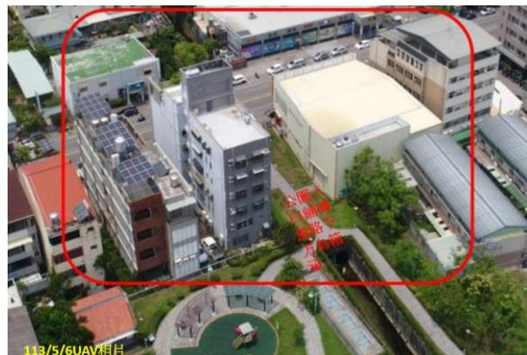
圖 3-54 霧峰中正路菜園溪旁 4 樓地下一層建物液化後傾斜沉陷拆除重建河道改為箱涵
