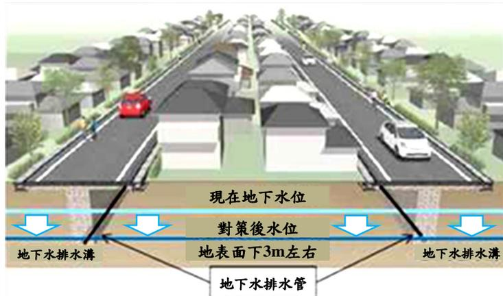
圖 2-8 公共設施和宅地一體型對策-地下水位降低工法示意圖(日本國土交通省，2019)[25]
