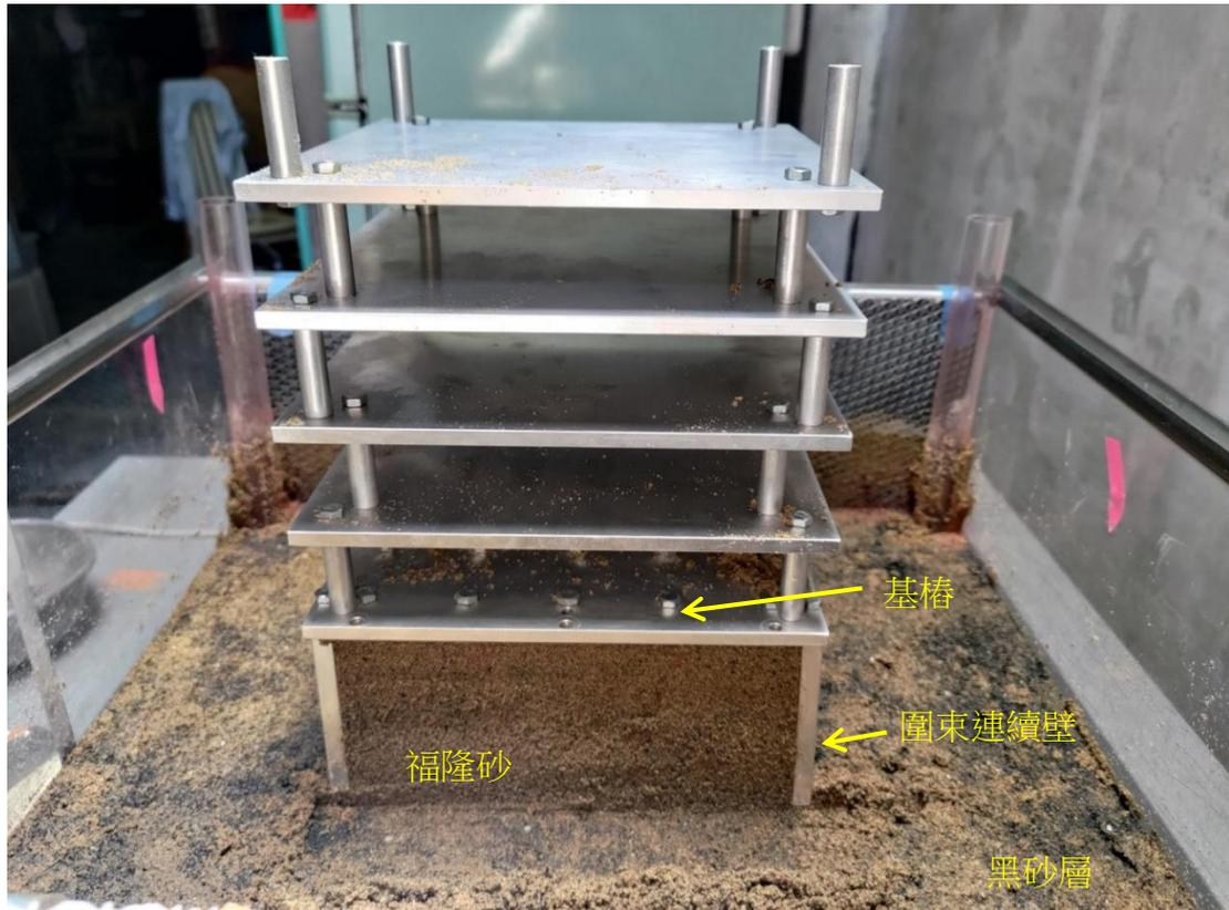
圖 5-25 高樓層模型組立過程照片—8.7cm 連續壁與 20cm 基樁貫穿黑砂層至底部礫石層
