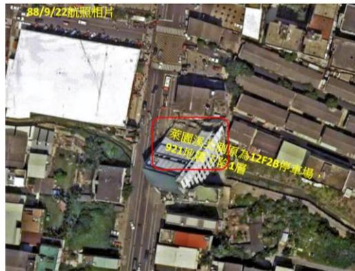
圖 3-53 霧峰中正路菜園溪旁 12 樓地下 2 層建物現況與液化後倒塌情況對照
