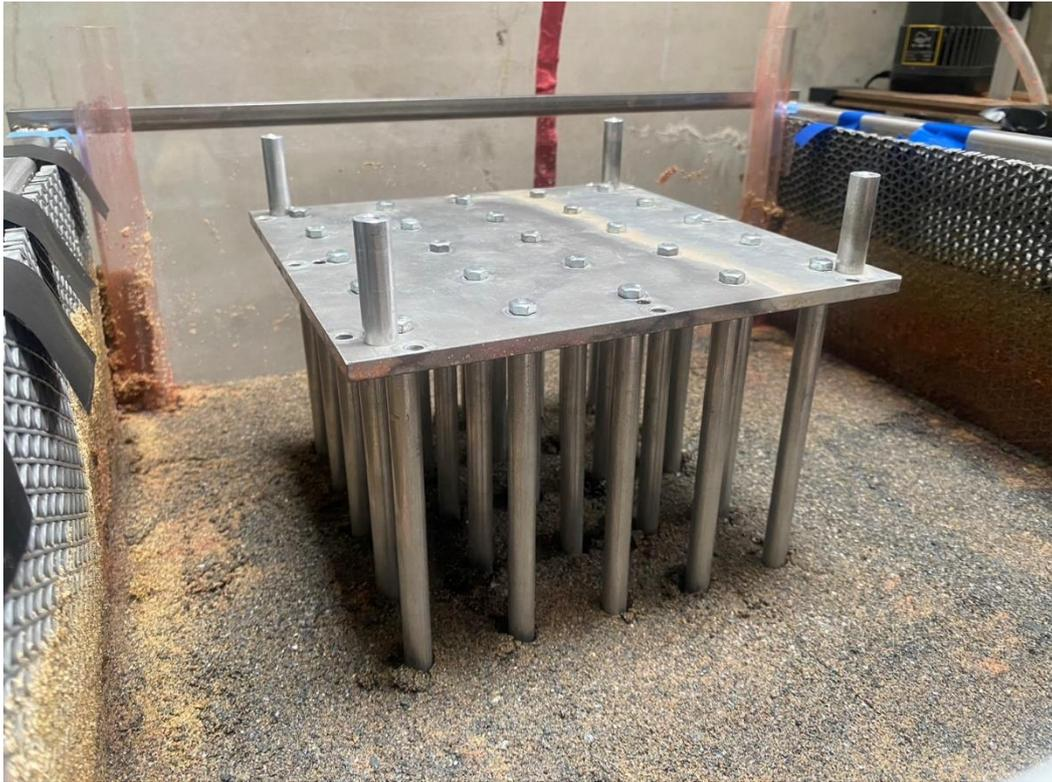
圖 5-74 基樁貫穿黑砂層進入底部礫石層作業情況
