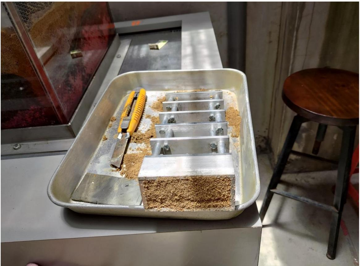
圖 5-32 5cmX10cm 長型模型壁體內回填砂情況
