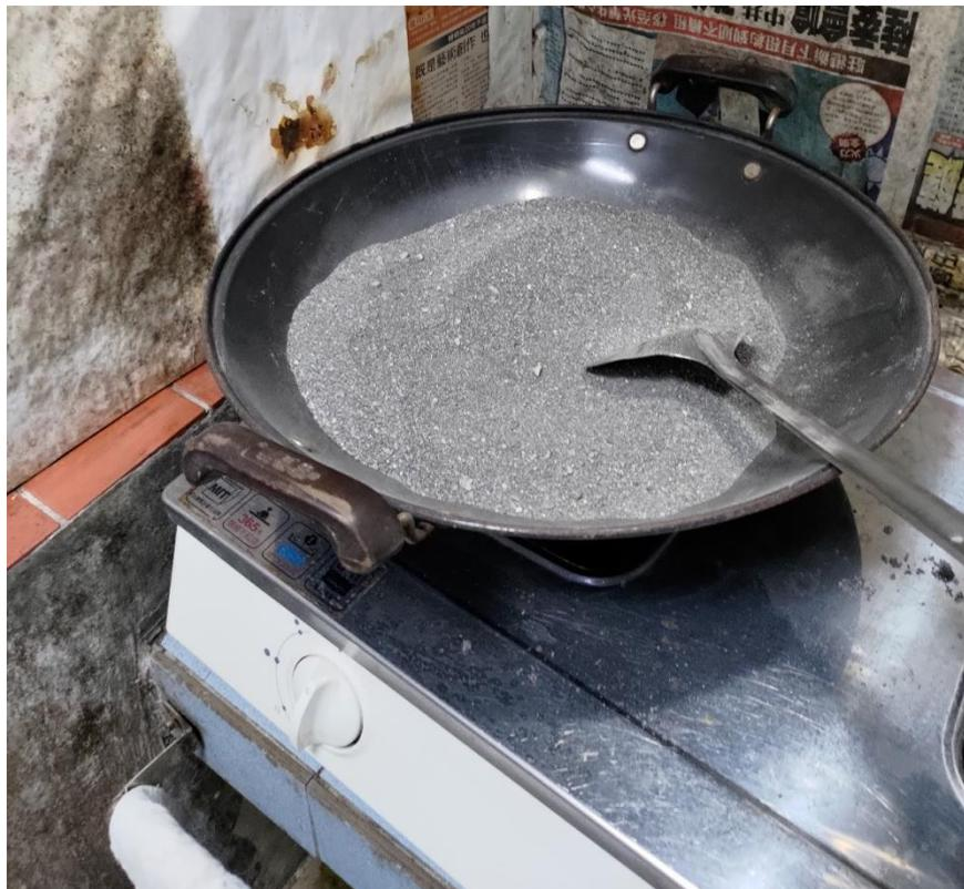
圖 5-18 試驗完後濕砂用鐵鍋炒乾實況
