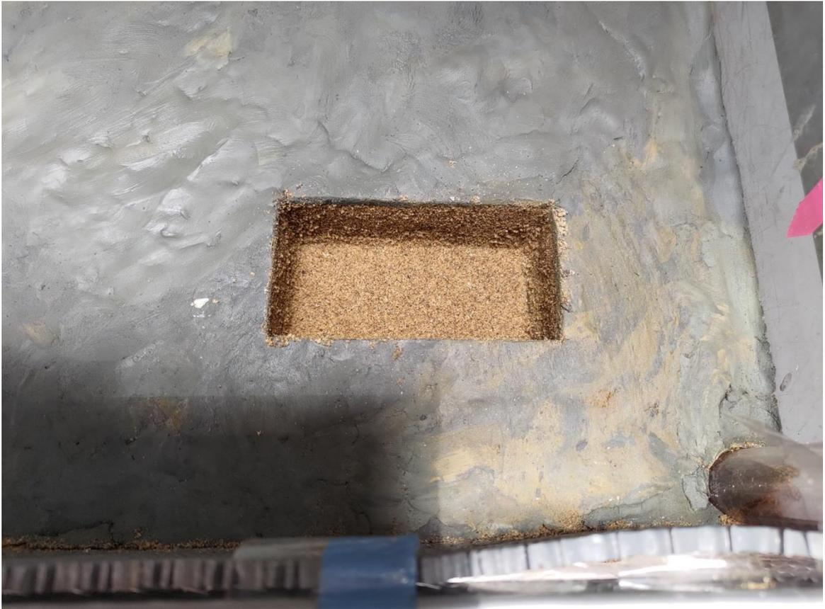
圖 5-31 上覆薄層黏土基坑開挖情況
