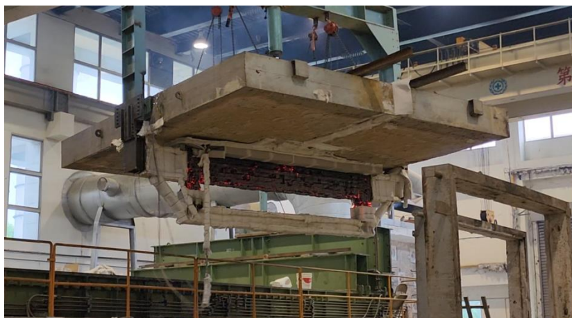
圖 3-20 第一組試體耐火試驗後吊出情形
