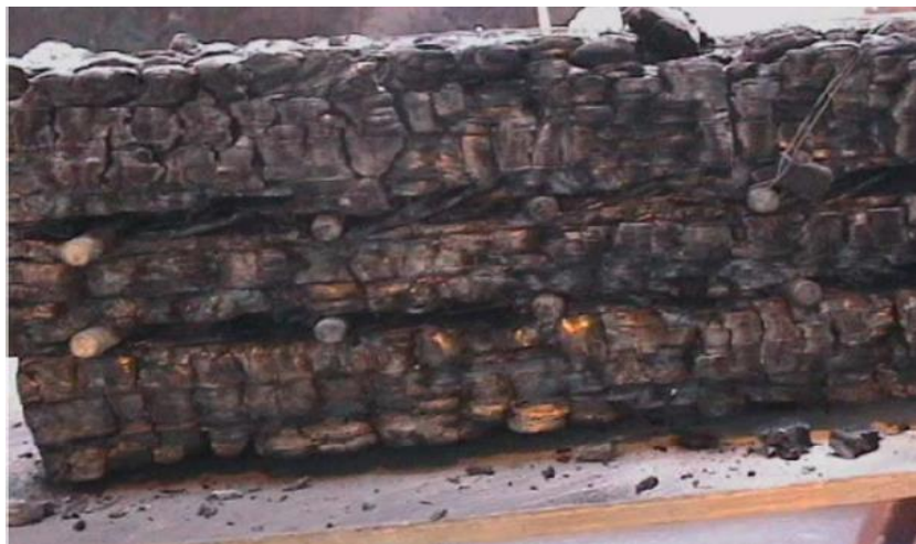
圖 1-4 使用金屬扣件接合部火害試驗結果[8]
