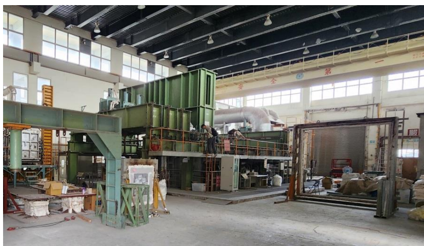
圖 3-7 建築研究所防火實驗室大型柱梁爐
