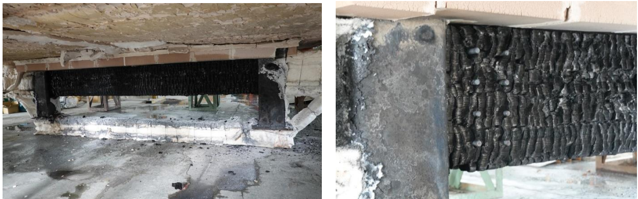
圖 3-29 試體火害後照片
