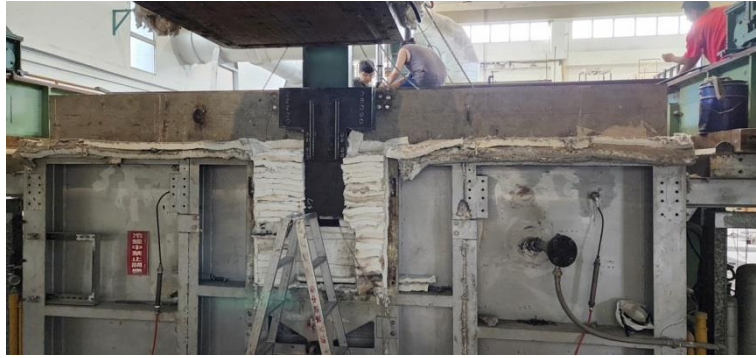
圖 3-18 試體安裝於柱爐後側邊開口的封裝情形
