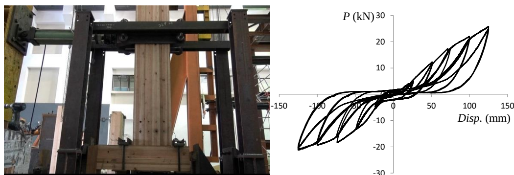
圖 4-7 CW_S 試體實驗照片與力量-變形遲滯迴圈
