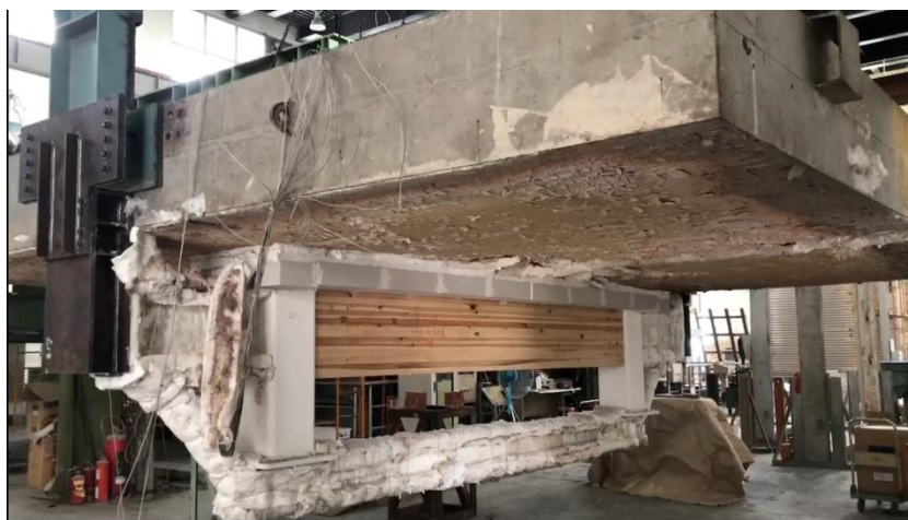
圖 3-17 第二組試體與爐蓋、反力框架組合後吊裝情形
