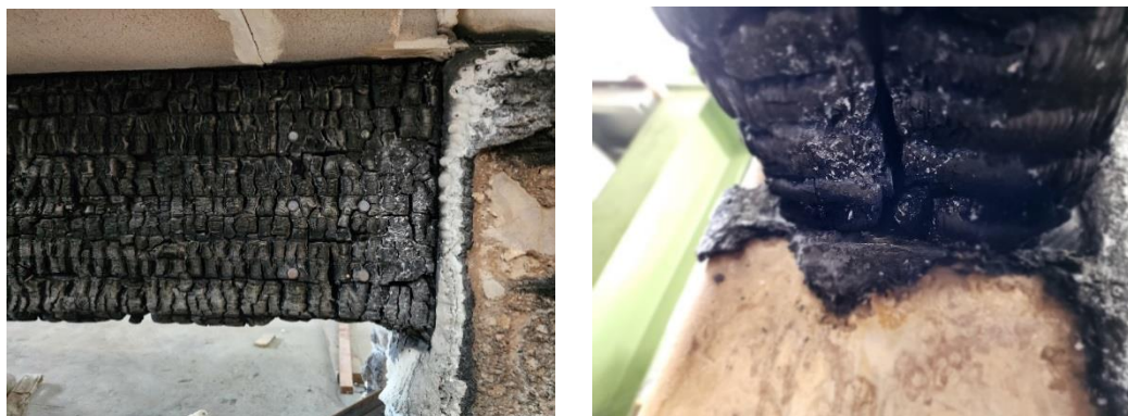
圖 3-34 試體火害後照片
