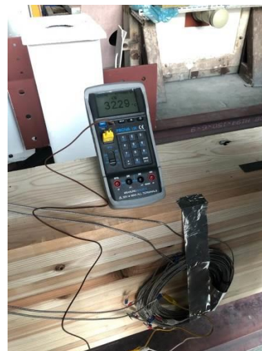
圖 3-14 木梁熱電偶安裝完測試情形
