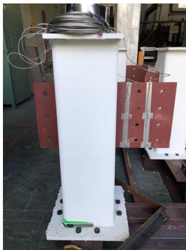
圖 3-13 鋼柱連接板安裝熱電偶情形
