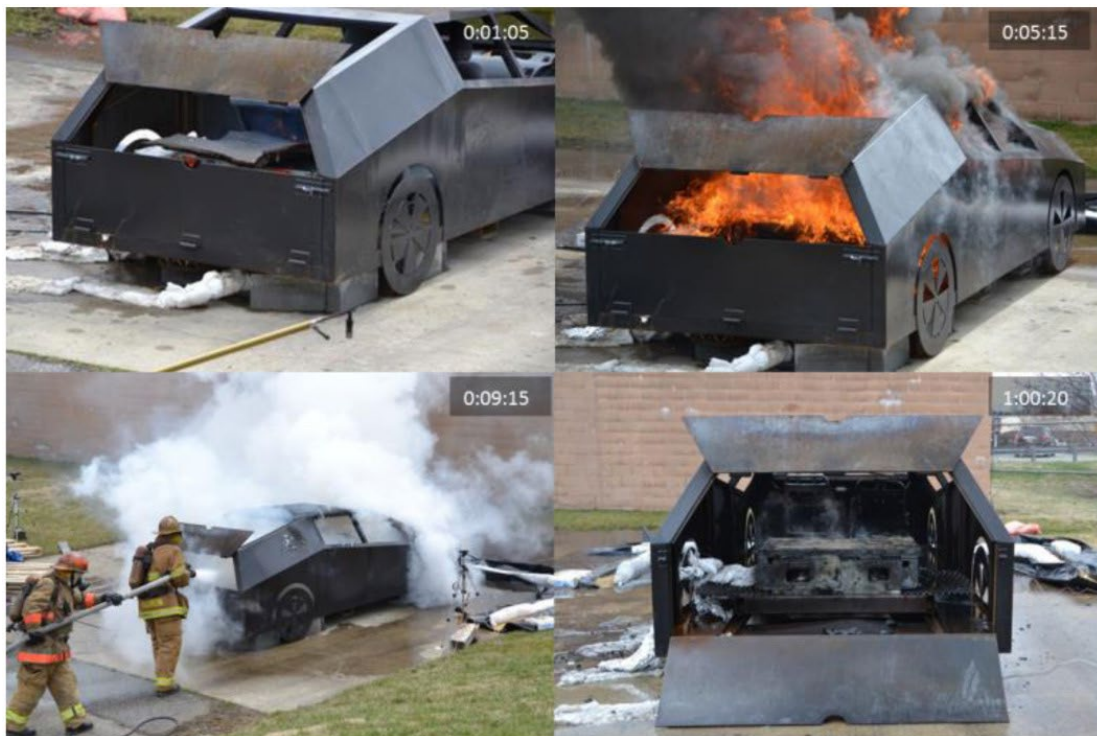
圖片說明：丙烷燃燒器點火（左上）、後方起火（右上）、第一次滅火（左下）、完成滅火（右下）
