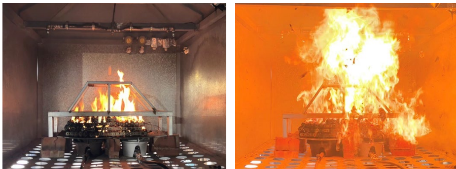
圖 3-95 氣閥洩漏瞬間_實驗一
