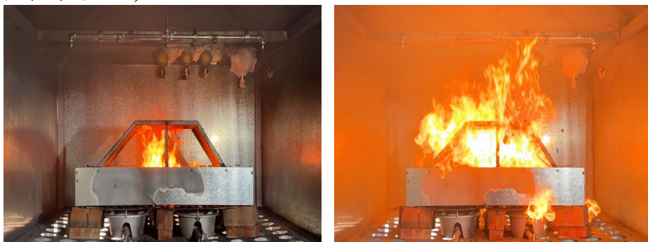
圖 3-96 氣閥洩漏瞬間_實驗二
