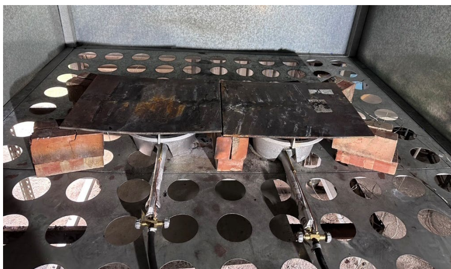
圖 3-82 加熱設備示意圖(快速爐及鐵板)
