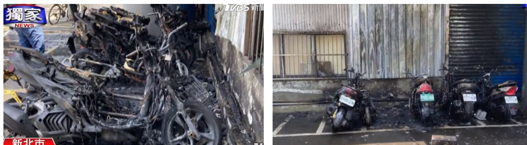
圖 3-14 (新北)電動機車電池起火延燒 12 輛機車 (資料來源：參考文獻【A21】)
