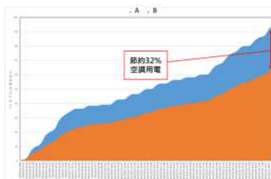
圖 5-31 五月份連續監測收集空調設備運轉用電統計節約電力 (資料來源：本研究製作)
