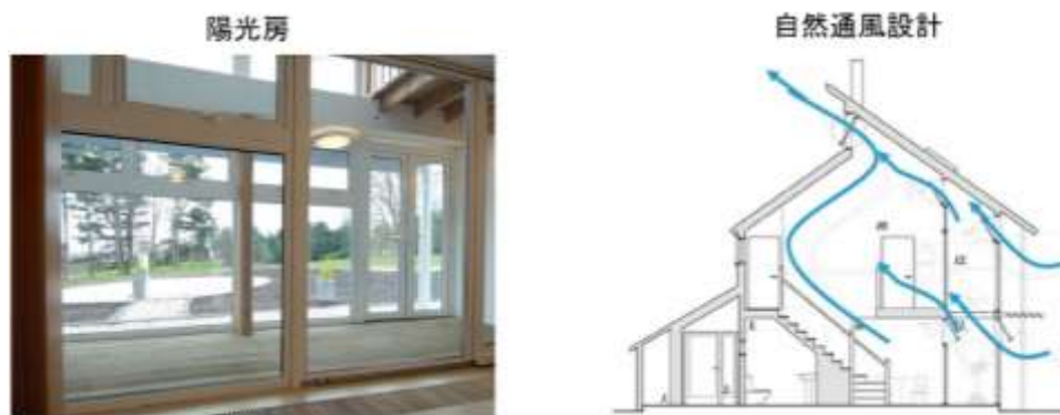
圖 3-25 BASF Research House 再生能源系統示意圖
