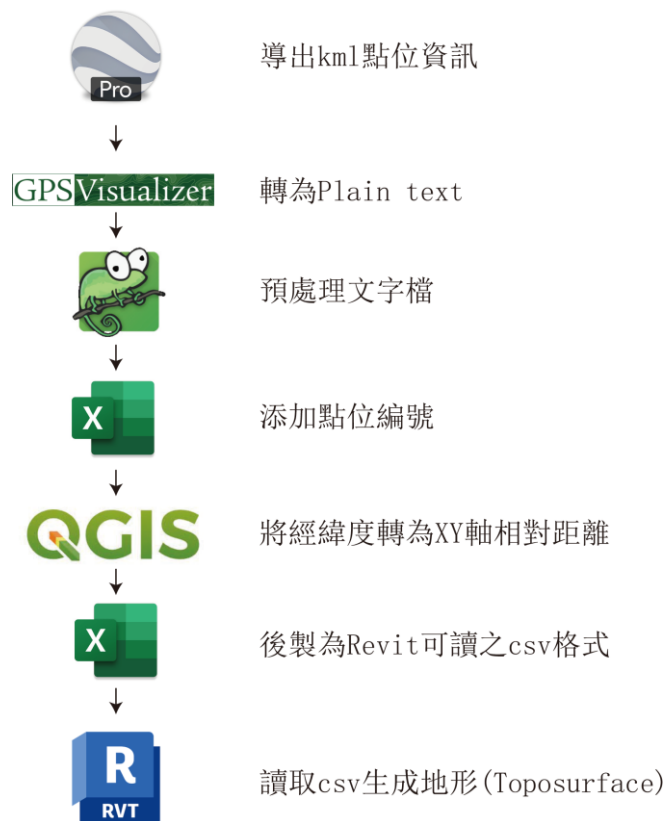
圖 5-5 將 Google Earth 地形數據複製到 Revit 流程圖(圖片來源:本計畫繪製)
