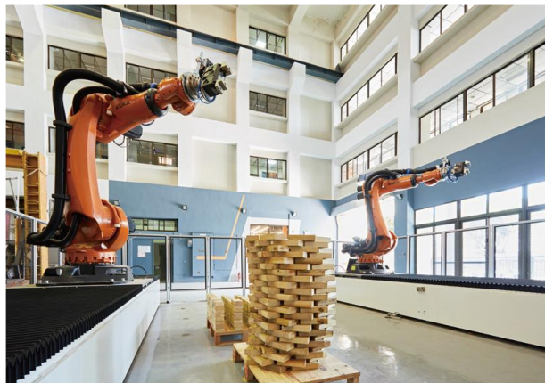
圖 3-12 整合工業機器人的建築生產流程（圖片來源:成大 RAC-Coon 數位智造工場）
