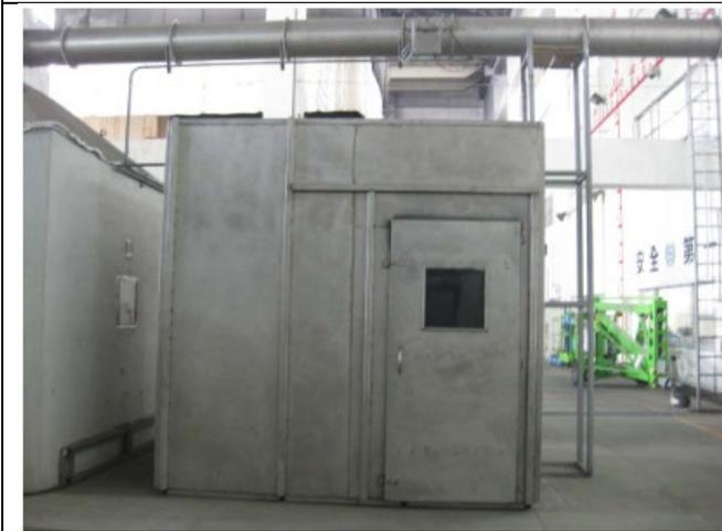
此研究設備依據 IEC 61034 標準針對電線電纜燃燒所產生之煙量進行測試，並量測其煙遮蔽率。
