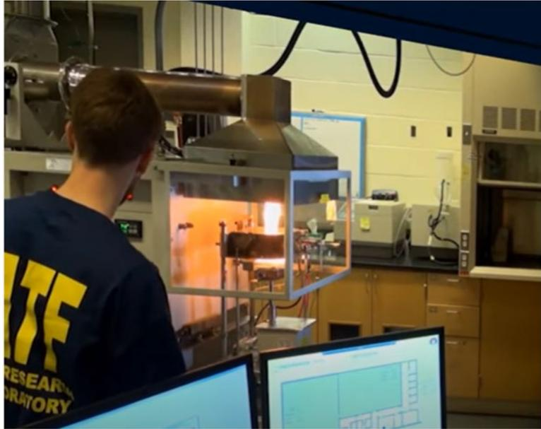
圖 2-40 圓錐量熱儀實驗照片
