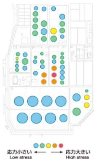
圖 2-32 工廠內儲槽遭受強震後的損壞程度預測
