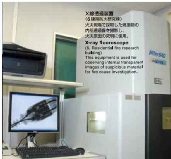
圖 2-15 X 射線透過裝置(X-ray fluoroscope)
