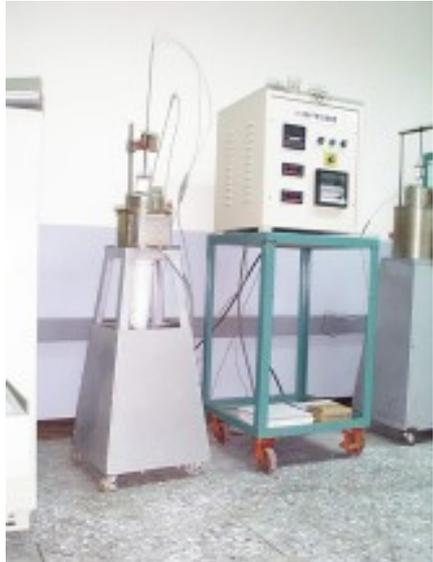
依據 ISO 1182 進行建築產品對防火測試的反應-不燃性測試，量測質量損失百分比、持續 5 秒以上的火焰、最高溫度與最終溫度之上升溫度差及加熱 60 分鐘內需達最終溫度平衡狀態。
