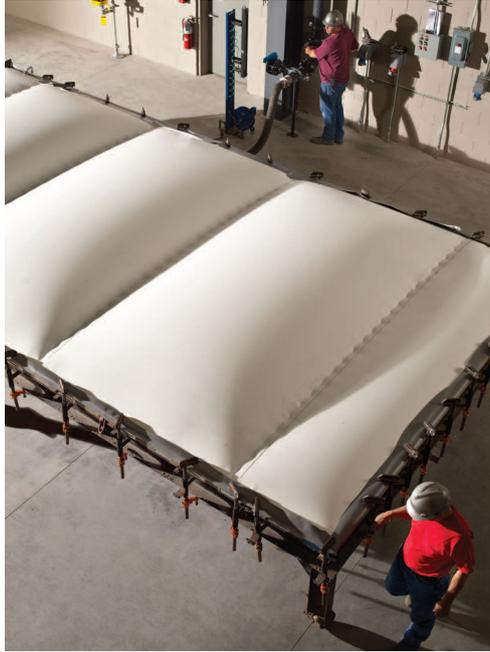
圖 2-65 屋頂膜進行起風測試
