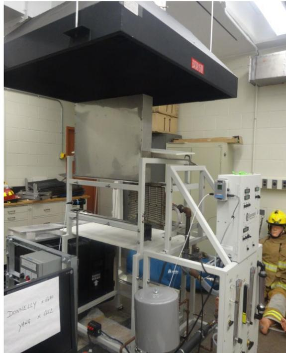
圖 2-50 壁裝材料延燒性測試裝置
