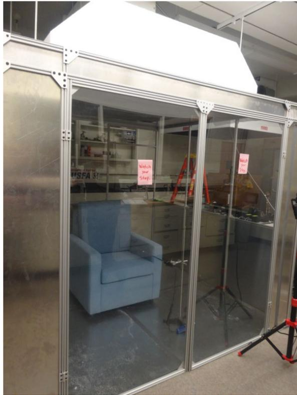
圖 2-48 軟式泡棉座椅家具阻燃性測試裝置
