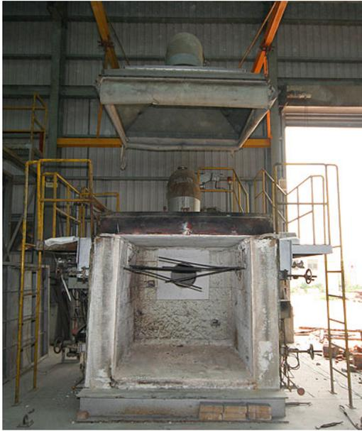
依據 CNS 11227-1、CNS 11227、CNS 12514-1、CNS 12514、CNS 15814、CNS 14514、CNS 11227、UL 263、UL 1479、UL 555、UL 10B、UL 10C 進行建築物構造部分之耐火測試，包括：牆壁、樑、柱、樓板、屋頂面及建築物防火區劃貫穿部之耐火測試，包括各種貫穿部防火材料 (Penetration fire stops)、膨脹型填塞、密封材、防火門(小尺寸)、防火五金之測試
