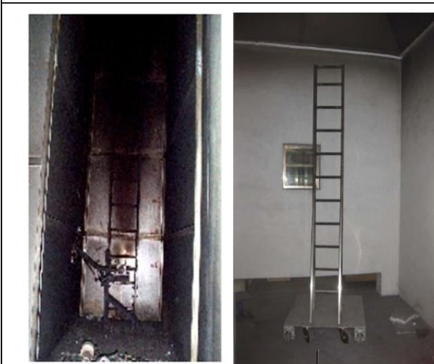
此研究設備依據 IEC 60332-3、IEEE 383、UL 1581 標準進行各式電力或電子傳訊用電線、電纜及光纖線纜之垂直火焰傳播性質進行測試。藉由觀察電線或電纜最下方接焰位置之最上方碳化位置之距離判斷其燃燒之長度。
