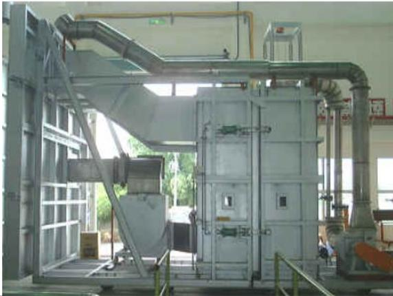
本實驗設備依據 CNS 15038 標準進行建築用門於室溫及中溫狀態下，透過門組件之洩漏量量測，評估其遮煙性能之試驗方法。
