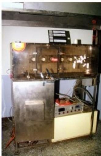
依據 ASTM E1678 進行各類材料及製品燃燒生成物毒性評估，包括有毒氣體分析及動物曝露試驗。
