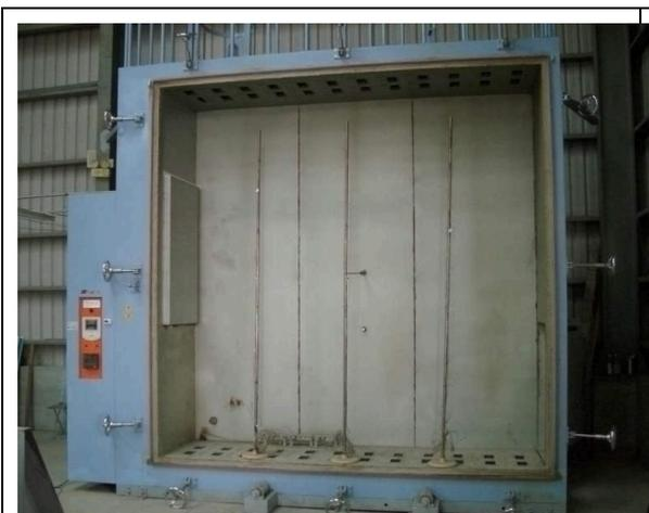
依據 CNS 15038、ISO/DIS 5925-1 及 UL 1784 進行建築用門於室溫及中溫狀態下，透過門組件之洩漏量量測，評估其遮煙性能之試驗方法。
