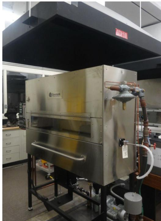
圖 2-49 地坪材料延燒性測試裝置
