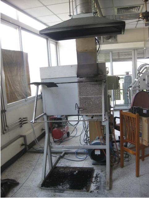
依據 ASTM E162、ASTM D3675、CNS 14819 進行延燒速率及發熱量之量測，評估材料表面耐燃性。
