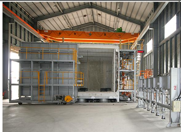
可依據前兩項之標準進行大尺度之防火門、防火捲門、防火固定窗及防火區劃貫穿部；建築物中各種室內分間牆與非承重之外牆；船舶檢測(垂直試體)之檢測。
