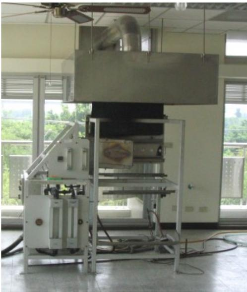
依據 ISO 5658、IMO Res.A 653(16)、ASTM E1317、ASTM E1321 進行牆面裝修材料水平側向著火及火焰傳播性質測試，量測熄火臨界通量、最大延燒距離、有效燃燒熱、總釋放熱及最大熱釋放率。
