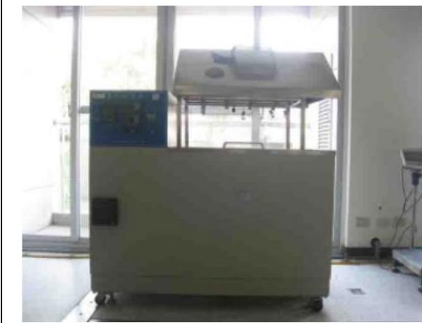
依據內政部消防署「密閉式灑水頭認可基準」、CNS 11254 檢測消防用撒水頭性能之試驗方法，本設備用以量測撒水頭玻璃球之冷熱衝擊試驗。
