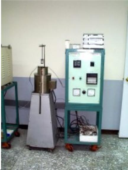
依據 CNS 6532、JIS A1321 進行各類室內裝修材料不燃性能測試(符合表面試驗耐燃一級材料)，量測其爐內溫度，以判定合格與否。
