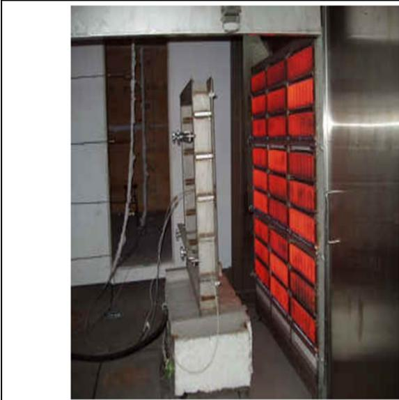
針對測定建築材料耐燃性能，量測垂直方位上  $1\text{m}^2$  樣本之熱釋放率，樣本暴露於由氣體燃燒之輻射板(最高至  $50\text{KW}/\text{m}^2$ )產生之均勻熱流，且瞬間點火，亦使用氧氣消耗原理來量測材料在模擬之真實火場之放熱、發煙及有毒氣體產生量。
