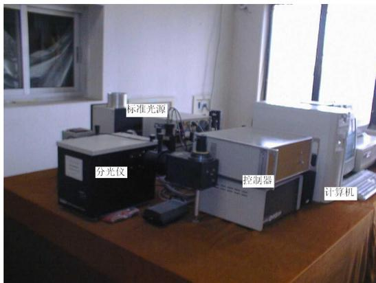
該實驗裝置由分光儀、控制器、電腦和標準光源四部分組成，分光儀是單色儀系統的核心部件，採用反射光柵進行分光。單色儀可測量獲取輻射目標在相應波段範圍的單色光強度，用於研究各種火焰輻射的特徵光譜，如在滅火劑存在前後火焰特徵光譜的變化等，從而為滅火機制理論研究提供重要實驗參數。
