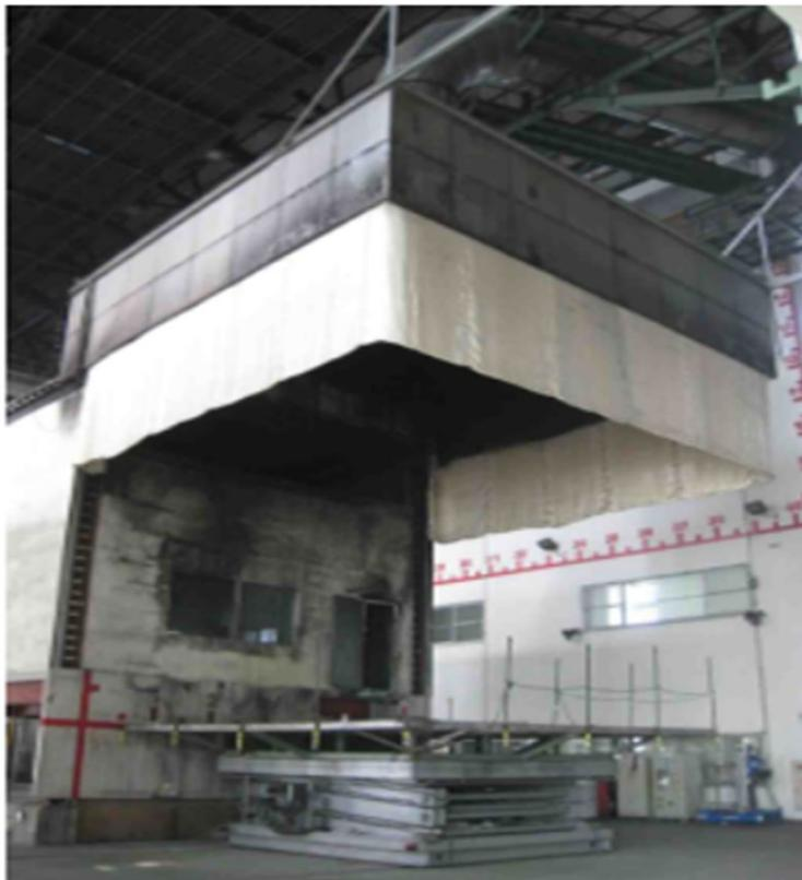
圖 2-11 10MW 大尺度量熱裝置
