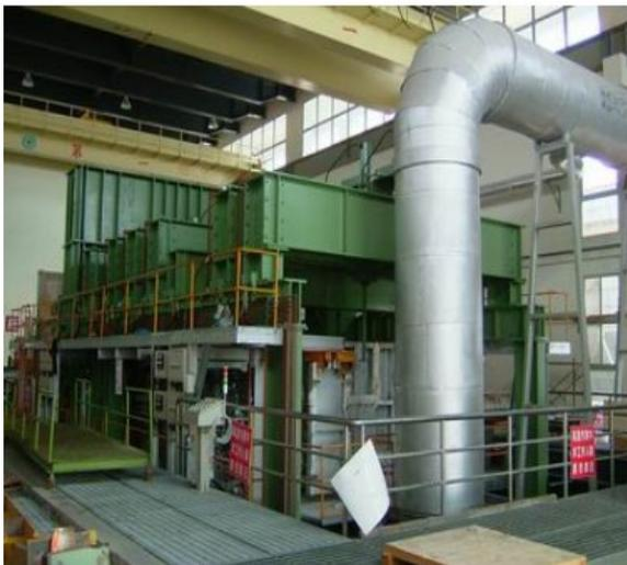
本試驗設備依據 CNS 12514 標準進行建築物樑、柱、樓板及屋頂構件之防火時效測定，可藉由觀察及量測其是否結構被破壞、火焰貫穿、撓度變化及背面溫度等數據評估。
