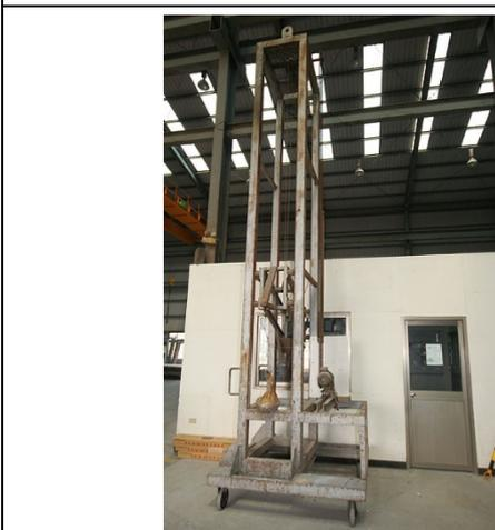
此實驗設備依據 CNS 11227、CNS 12514、CNS 14803、CNS 14815 標準進行建築物防火門、捲門、窗、隔間牆及承重牆構件有無顯著破壞脫落測試。
