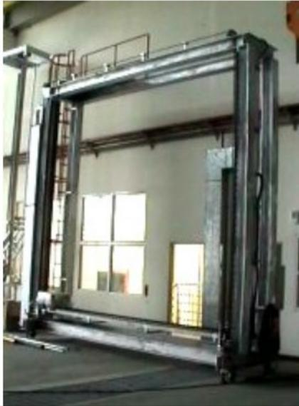
此實驗設備依據 CNS 11227 標準進行建築物防火門及防火捲門進行其撓度變化。
