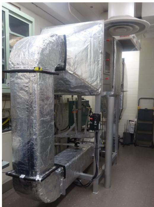
圖 2-51 NIST 自製消防人員設備耐高溫性測試裝置
