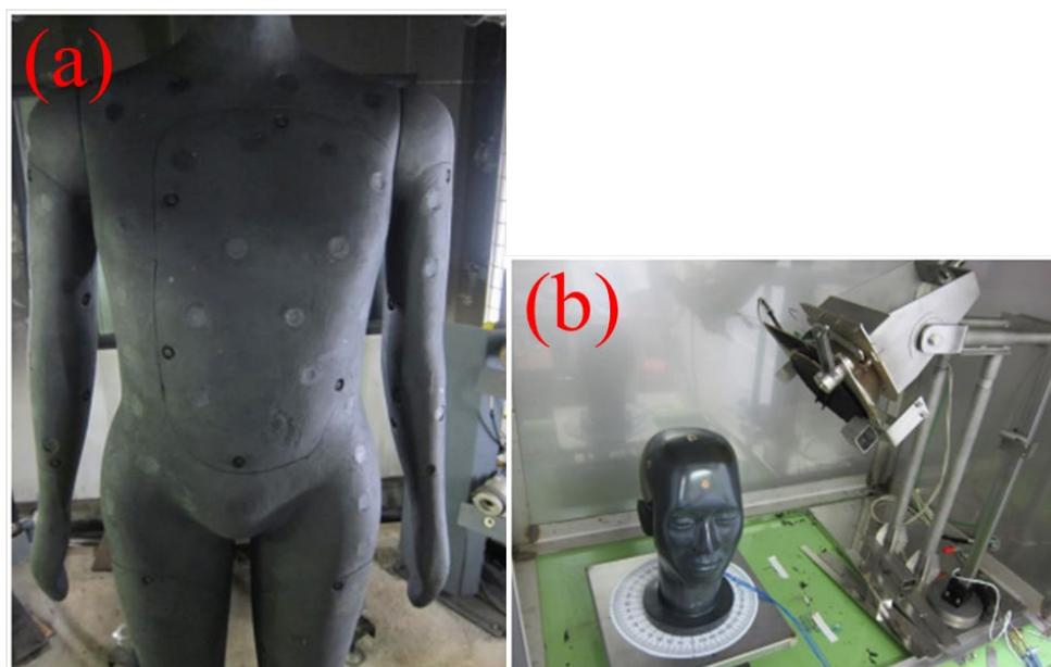
圖 2-13 (a)消防衣檢測設備(b)消防頭盔檢測設備
