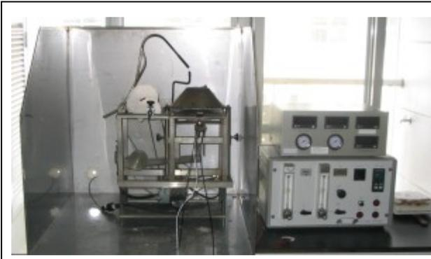
依據 ISO 5657、BS 476:part 13 進行各類材料表面引燃難易特性測試，量測最小引燃熱通量及最小引燃時間。
