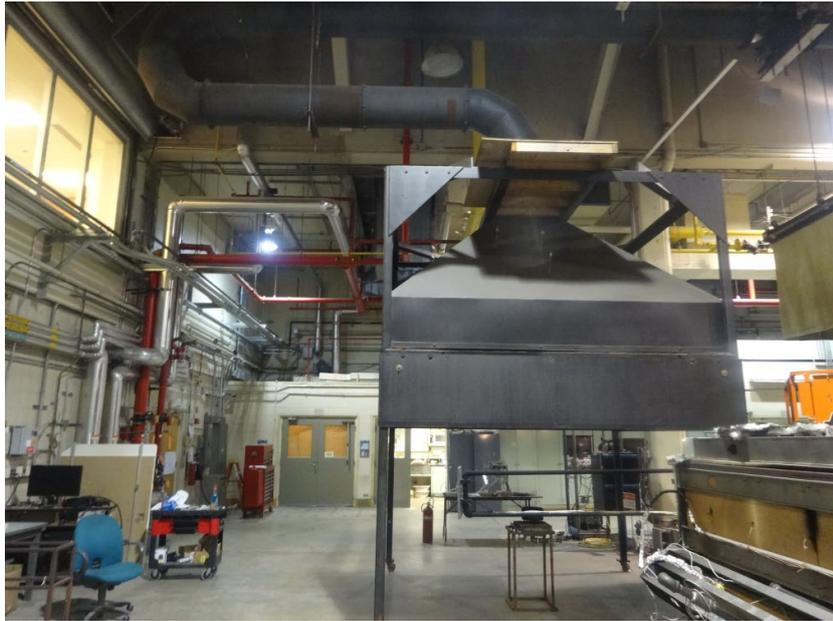
圖 2-44 1 MW 量熱裝置<sup>23</sup>
