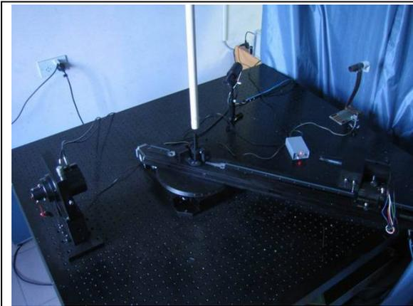
完整的光散射特性可以通過散射矩陣來描述不同顆粒群的散射特性，本實驗台有連續的顆粒群發生裝置，可實現火災煙霧(棉繩、木材、液體火、檀香等)及干擾性顆粒群(灰塵、水蒸氣等)，在得到穩定的測量段後，入射激光作用於顆粒群，發生光散射後由步進電機控制的光學檢測探頭對不同角度的光學信息進行連續檢測，得到不同顆粒群的光學散射全角度信息，為提高通過光散射信息來分辨不同類型的顆粒群提供依據。
