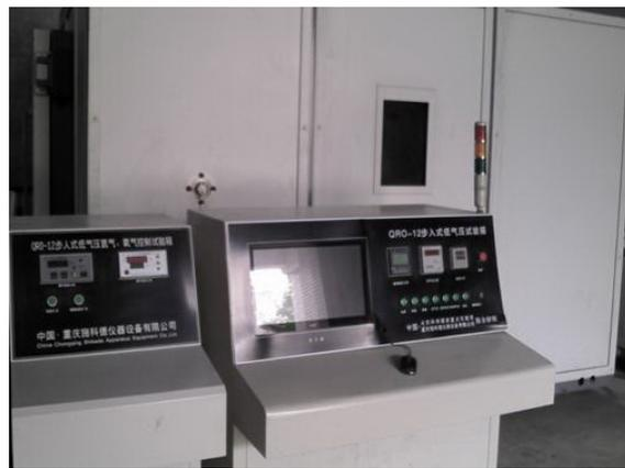
步入式低氣壓試驗箱採用承壓式方型結構，配備自閉式承壓保溫門、雙層鋼化玻璃觀察窗及氧氣、氮氣含量控制系統。自動化程度高，操作簡便，能夠模擬低壓低氧之高原火災環境，可通過有規律的改變低壓艙內的氧濃度和壓力條件研究材料的熱解、火蔓延規律、煙氣特性及探測報警器的響應機制等。
