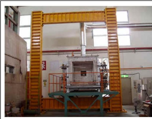
本設備依據 CNS 14514 進行建築物防火區劃貫穿部試驗，判斷貫穿部耐火材料之遮焰及阻熱性能。
