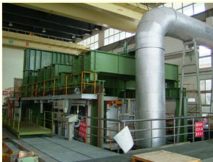
圖 2-6 耐火構造實驗場中耐火樓板複合實驗爐
