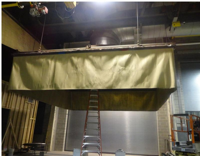
圖 2-45 3 MW 量熱裝置
