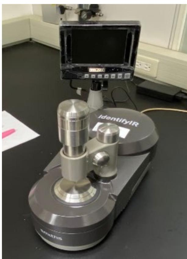
圖 2-73 顯微傅式紅外線光譜儀
