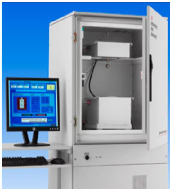
加速量熱儀可用於模擬絕熱條件下物質的放熱反應，準確記錄反應時的溫度、壓力及反應速隨時間的變化。利用專用軟件分析得到測量物之反應熱、活化能及達到最大反應速率的時間，為放大生產提供安全數據。
