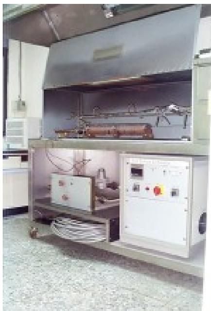
依據 CNS 11359、IEC 60331 標準評估電力及通訊用線纜受火燃燒情況下能否維持正常輸電功能。
