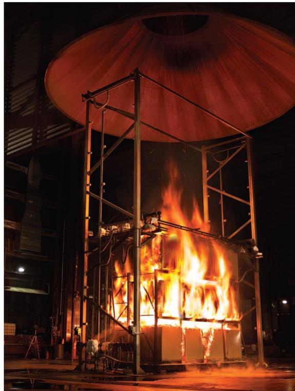
圖 2-59 於 20 MW 之抽氣罩下方進行大型倉儲火災實驗
