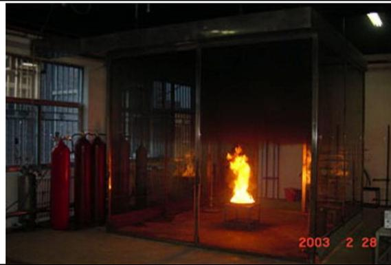
細水霧滅火模擬實驗台採用低壓泵和管網系統，自動化程度高，操作簡便，且能夠開展各種基於細水霧的模擬滅火實驗。可用於研究各種細水霧噴頭之 K 係數、細水霧的特性參數、細水霧對不同類型火災之滅火效能等，可測量細水霧滅火實驗中的火焰溫度、熱輻射通量及特徵氣體濃度變化等多項參數。
