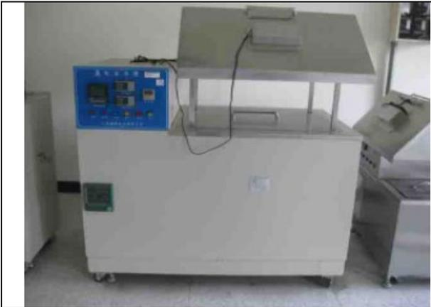
依據內政部消防署「密閉式灑水頭認可基準」、CNS 11254 檢測消防用撒水頭性能之試驗方法，本設備用以量測撒水頭玻璃球之冷熱衝擊試驗。
