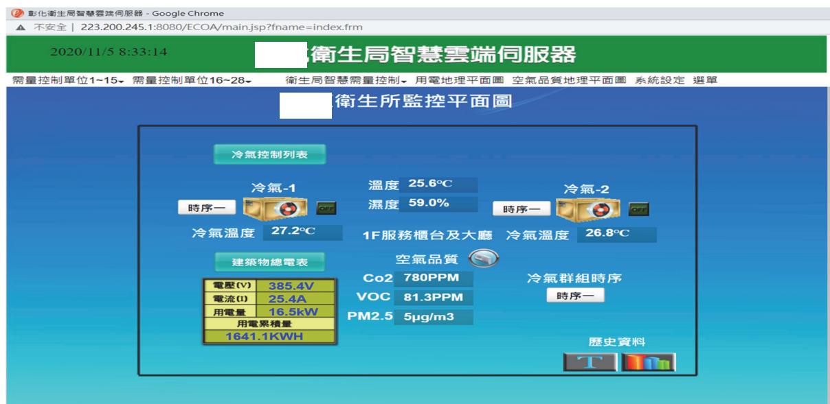
圖 2-23 某 C 縣所轄某衛生所卸載二台空調後之耗電量為 16.5 kW
