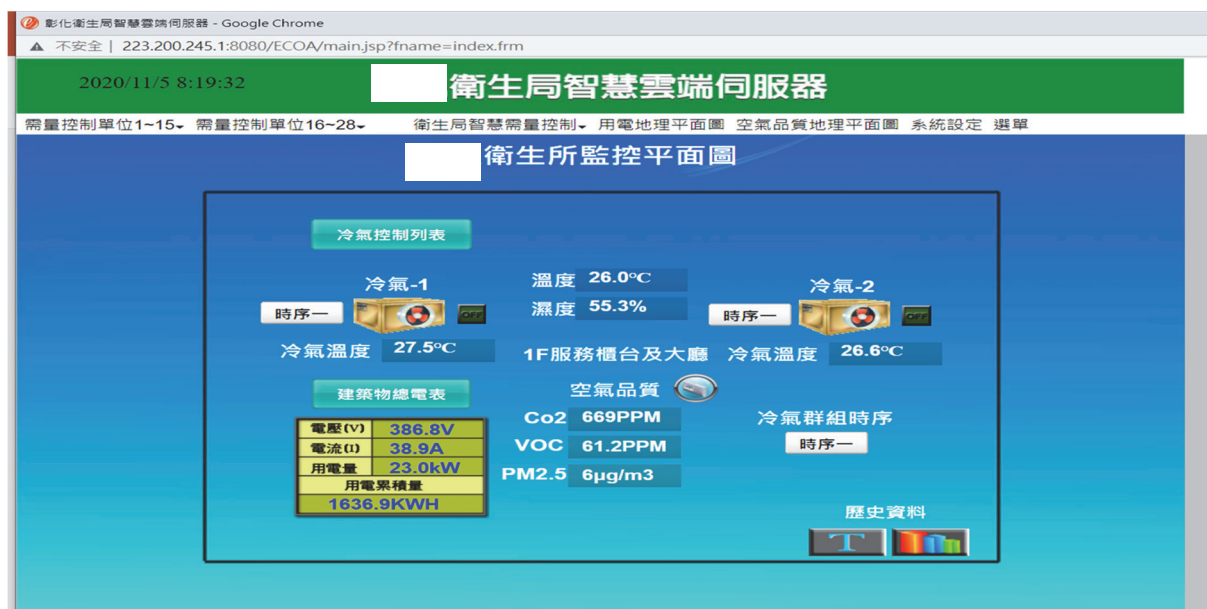
圖 2-19 某 C 縣所轄某衛生所開啟二台空調時之耗電量為 23 kW
