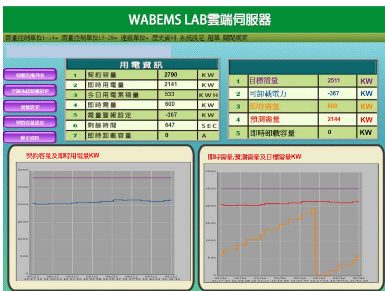
圖 3-26 進入「WABEMS B」空調卸載之操作畫面 (資料來源：本研究整理)
