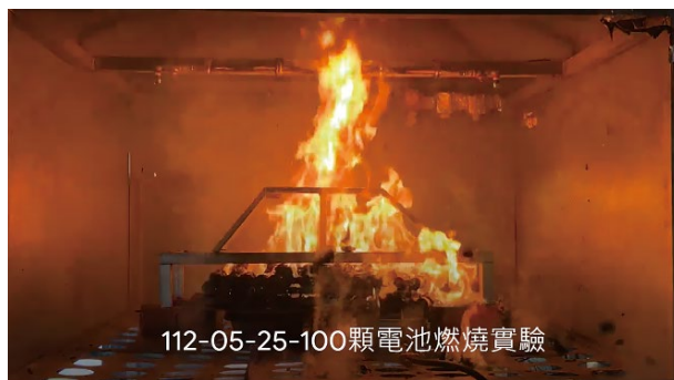
電動車鋰電池小規模燃燒實驗
