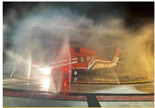
黑鷹直升機動態清洗作業
