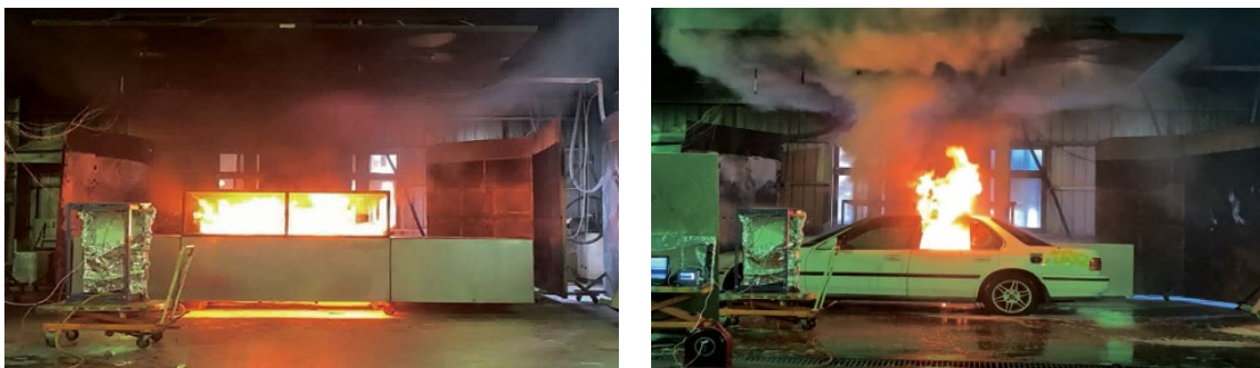
模擬停車空間之汽車火災及撒水滅火實驗（左：模擬車體燃燒實驗，右：實際車體燃燒實驗）
