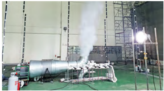
建築研究所開發之熱煙發煙量設備提供現地熱煙試驗驗證應用
