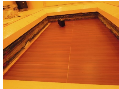
(b) 輕量衝擊源樓板衝擊音測試
