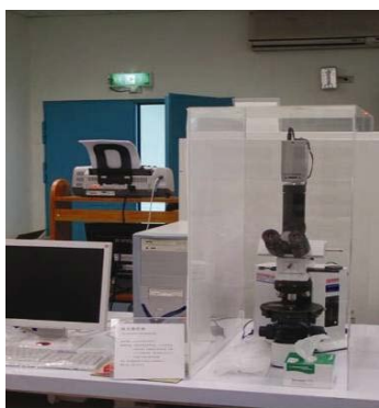
圖 3-2 偏光顯微鏡-石綿檢測設備
