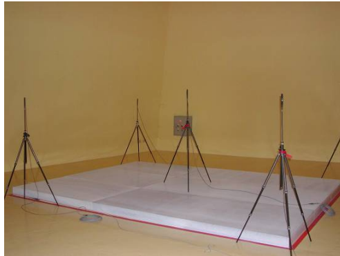
圖 7-20 吸音性能量測實驗室
