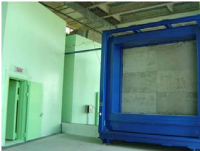
(a) 牆板隔音測試設施
