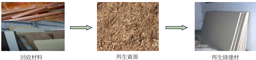
圖 6-2 木質材料回收製造再生綠建材流程
