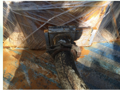
試體下方壓力灌漿入料閥 與幫浦車之泵送管連接
